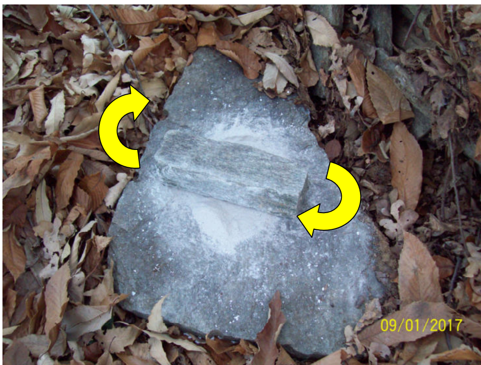
Fig. n. 226 : riduzione in sabbia fine delle varie componenti per la produzione del vetro grazie alla semplice rotazione e leggera pressione tra due pietre piatte.
