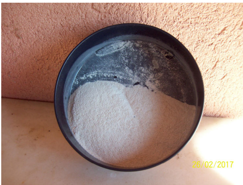
Fig. n.227 : miscela finissima di quarzite, dolomia e soda pronta per la fusione.
