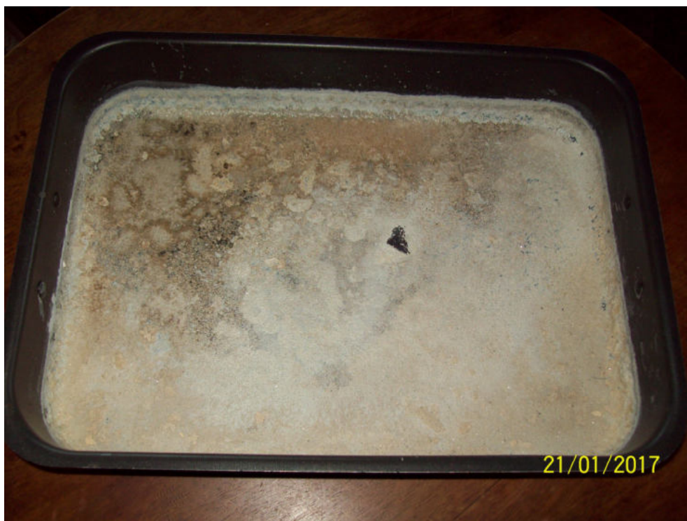
Fig. n. 231: soda prodottasi per semplice evaporazione dell'eluato ricavato dalla cenere di legna.
