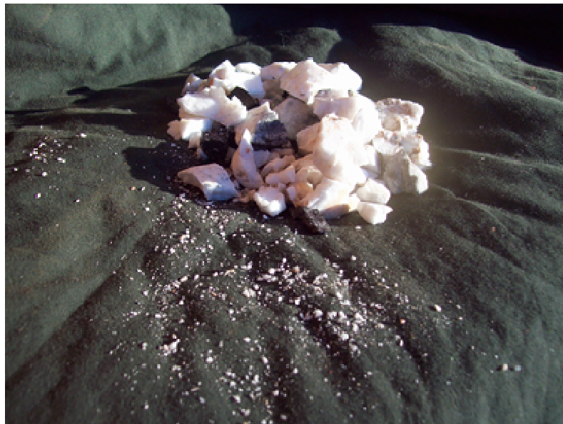
Fig. n. 223 : frammentazione termica del stesso ciottolo. Grazie ad una leggera pressione le dimensioni maggiori dei frammenti si riducono a quelle di una sabbia facilitandone la fusione.
