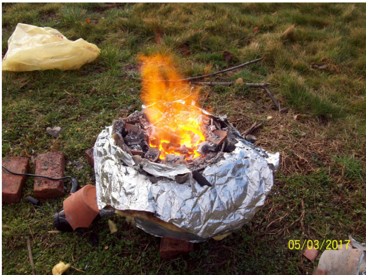
Fig. n.242: fornace in funzione: l'immissione di aria è stata creata mediante l'utilizzo di un phon. La temperatura deve essere salita a valori nettamente superiori ai 1.500°C.
