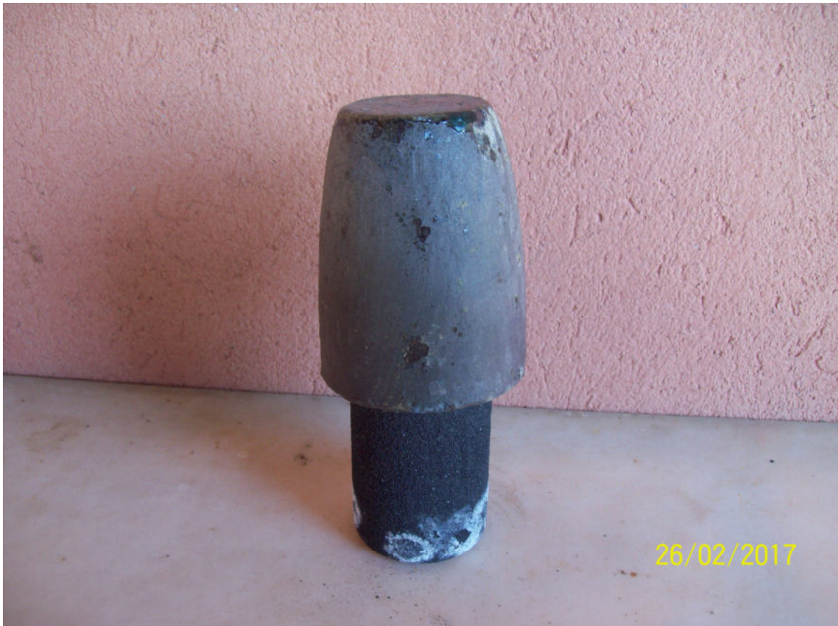
Fig. n. 240: crogioli di grafite utilizzati per la fusione; in quello inferiore è stata messa la miscela di quarzite, soda e dolomia alla quale è stato aggiunto un filo di rame al fine di ottenere una certa colorazione.
