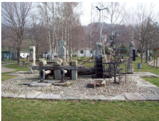
Fig. n. 221 : Comune di Andrate. Ricostruzione di un vecchio maglio idraulico funzionante sino a metà novecento in una officina meccanica a valle dell'abitato di Andrate ( Regione Piste). Il maglio utilizzato dai romani era pressoché analogo.
