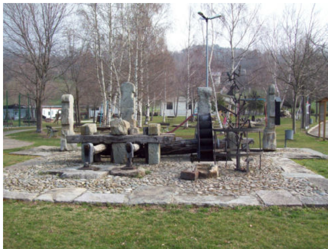
Fig. n. 113 : Comune di Andrate. Ricostruzione di un vecchio maglio idraulico funzionante sino a metà novecento in una officina meccanica a valle dell'abitato di Andrate ( Regione Piste). Il maglio utilizzato dai romani era pressoché analogo.
