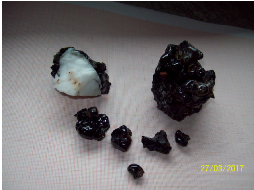
Fig. n. 245: masse vetrose bruno-verdastre per presenza di ferro ; la quarzite bianca certifica che la temperatura non è arrivata alla temperatura di fusione del quarzo prossima a 1.700°C ma ha superato quella del ferro ( 1500 °C ca. ) .
